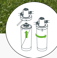
Einfacher Kartuscentausch ohne Werkzeug
